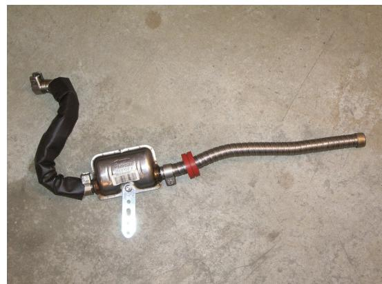
Выхлопной глушитель крепиться с помощью монтажной пластины – под болт массы. Использовать термоизоляцию выхлопной трубы. Для промежуточного крепления выхлопной трубы после глушителя используется Г-образный кронштейн. Проход пластиковой защиты картера с использованием термостойкого дистанционного кольца с пазом.
