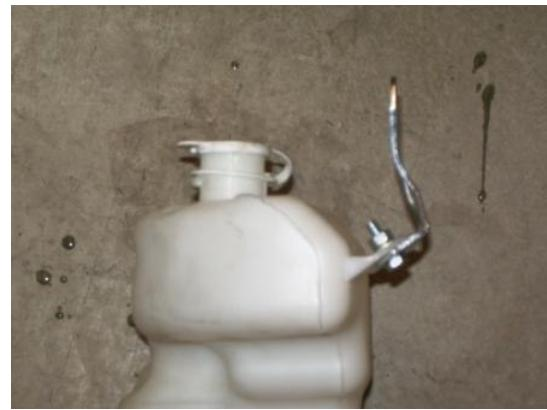
В местах соприкосновения с металлом – наклеить двухсторонний скотч или другой демпфирующий материал. С помощью пластиковых хомутов – фиксация к кронштейну бампера. Изогнуть монтажную пластину по месту для фиксации к штатной гайке (M6) и кронштейну бачка. Удлиннить на 450 мм шланг к радиатору внутренний Ø 8мм.
