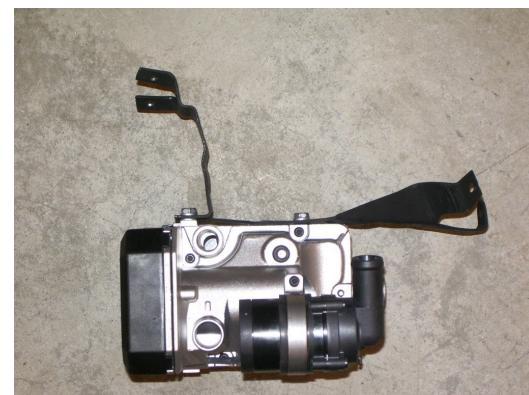
Вертикальный кронштейн представляет собой штатный выпрямленный кронштейн с одним удаленным ухом. Верхняя точка фиксации к отопителю – оставшееся ухо, нижняя – просверлить отверстие по месту после примерки на автомобиле – (отопитель установить
