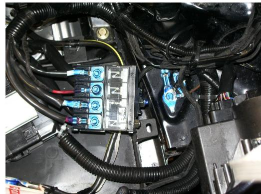
Минитаймер устанавливается слева от руля. Вентилятор активируется по схеме с дополнительным реле и шунтом. При прокладке жгута в салон необходимо заложить провод сечением  $3\div4\text{мм}^2$  от дополнительного реле управления мотором вентилятора до шунта.
