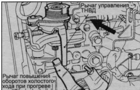
ТНВД для 4М40 (винт максимальной частоты вращения показан стрелкой).
