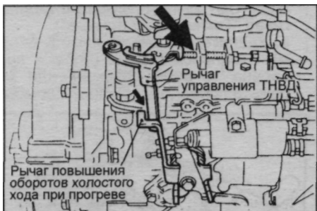
ТНВД для 4D56 (винт максимальной частоты вращения показан стрелкой).
